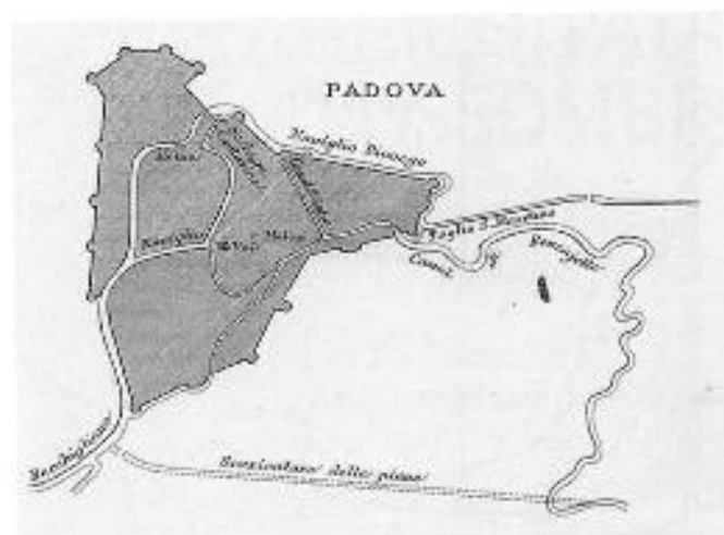
2. Corografia e prospetto dell'intervento "Taglio di S. Massimo" previsto per mettere in comunicazione il Canale Piovego con il Canale Roncajette.
