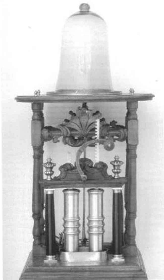
Pompa da vuoto a due cilindri di Haaksbee, XVIII secolo. Si tratta di uno dei modelli più importanti dei primi anni del Settecento, ideata. È caratterizzato dall'impiego di due cilindri, all'interno dei quali due pistoni venivano messi in movimento mediante un meccanismo a cremagliera e ruota dentata. La pompa in esposizione, figura tra i primissimi strumenti del Teatro di Filosofia Sperimentale di Giovanni Poleni. [Museo di Storia della Fisica, Università di Padova].
