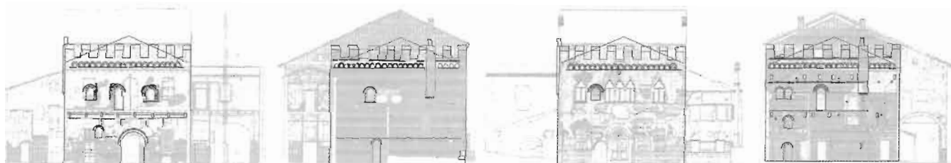
I fronti attuali di Palazzo Orsato celano l'edificio romanico originario. Il disegno mostra l'aspetto che doveva avere la casa-forte, ricostruito sulla base delle tracce ancora leggibili.
