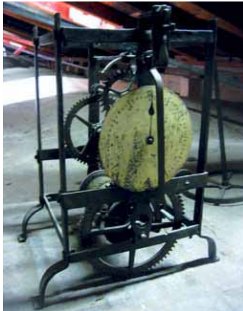
Meccanismo dell'orologio (attualmente non collegato ai quadranti e in attesa di restauro).
