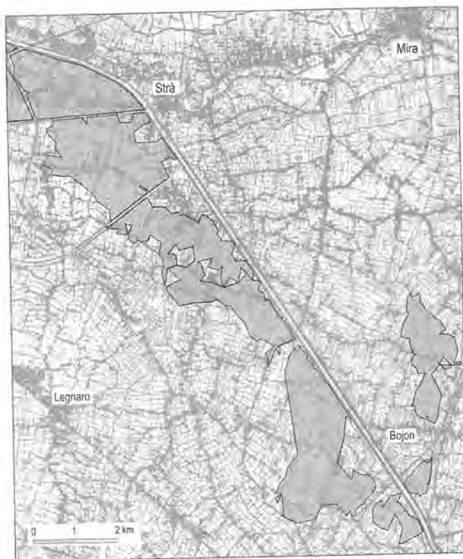
6. Modello matematico bidimensionale. Allagamenti prodotti dal Brenta a valle di Strà e nel Piovese per una piena comparabile con l'evento del 1966.
