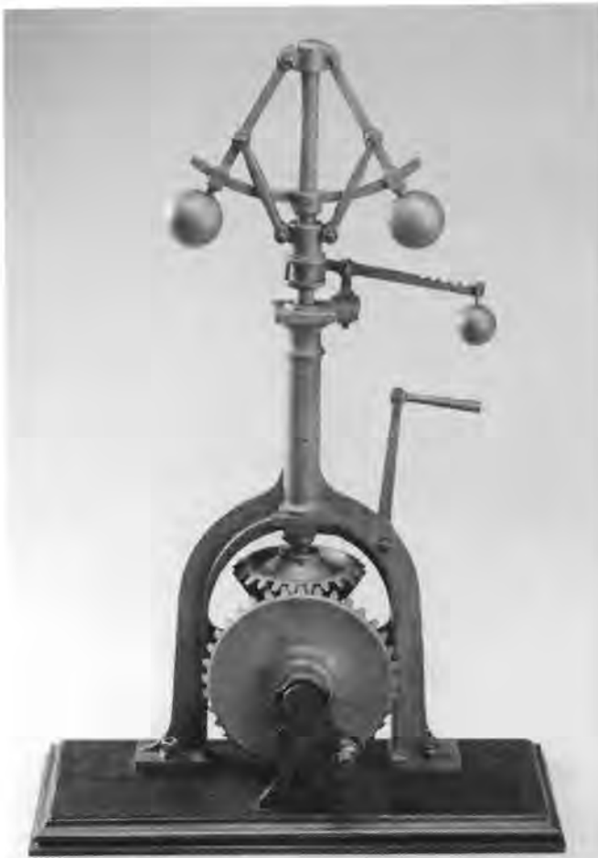
Modello di cinematica in legno usato per lo studio della forza centrifuga. (Mario Iral - 27/12/2005).
