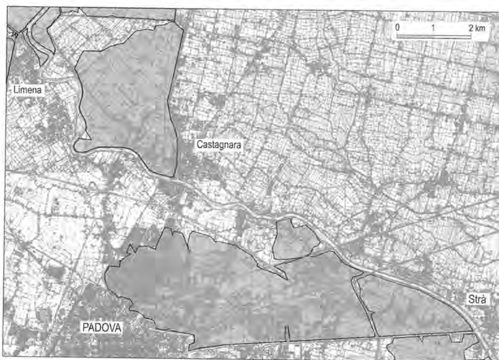
5. Modello matematico bidimensionale. Allagamenti nella zona di Padova prodotti dal Brenta per una piena comparabile con l'evento del 1966.
