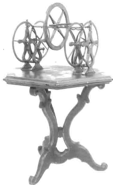
*Macchina delle parabole dell'argento vivo. Il mercurio, contenuto nel serbatoio posto a coronamento, usciva dal rubinetto con angolarità regolabile, formando un getto parabolico.*
