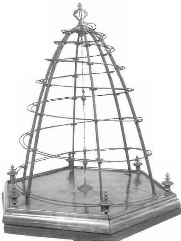
*Il paraboloide di père Sébastien Truchet per la verifica delle leggi cinematiche dei gravi.*
