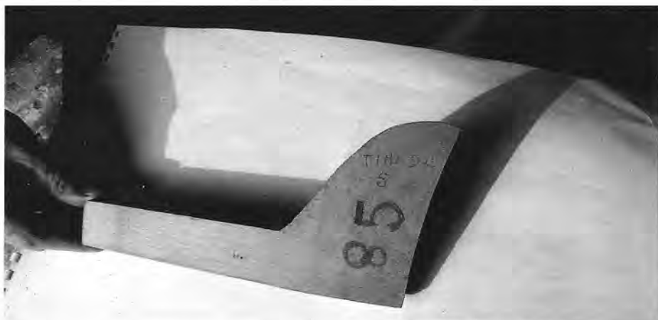
2 La "cagna", fra vari tipi di pialle. 3 Compasso, ziniatore e altre pialle. 4 Cerchi per botte. 5 Sagoma per stabilire la capacità del tino.
